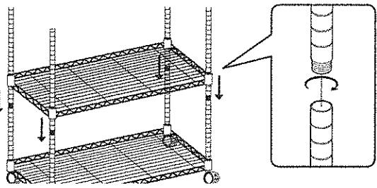
⚠️ 上部ポールを取り付けるときに、必ず垂直に取りつけてください。斜めに取り付けるとジョイントがボールに入らなくなります。
