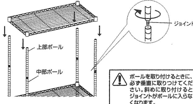
**!** ボールを取り付けるときに、必ず垂直に取り付けてください。斜めに取り付けるとジョイントがボールに入らなくなります。
