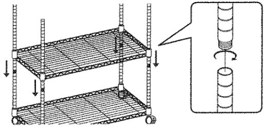
**!** 中部ボールを取り付けるときに、必ず垂直に取り付けてください。斜めに取り付けるとジョイントがボールに入らなくなります。
